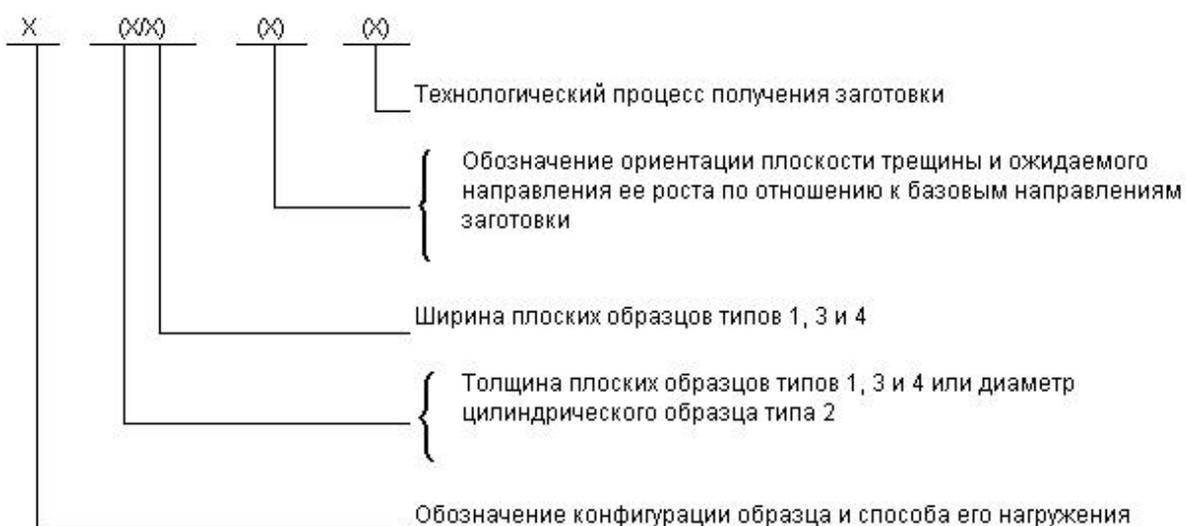
9.1. Обозначение конфигурации образцов и способа их нагружения по п.2.1 настоящего стандарта.
